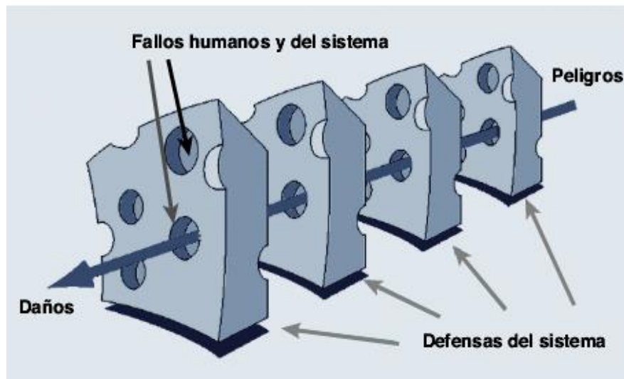
Fuente: Reason J. Human error: models and management. BMJ 200; 320:769. Figura N. 2 El modelo del queso suizo de Reason en la producción de accidentes.
