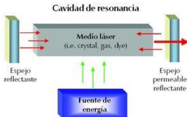
Fig. 6: Componentes del elemento productor del láser. La estructura física contiene el medio (gas o cristal) entre un resonador con dos espejos, a través del cual se emite el láser, los fotones son reflejados entre los espejos y producen cada vez más fotones. Cuando el medio se satura, escapa el 10% de los fotones que formarán el rayo láser. Se necesita una fuente de energía que estimule los electrones.
