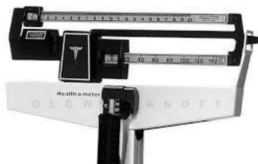
**Fig. 4 Escala de valoración graduada de la balanza de pie con tallímetro**
